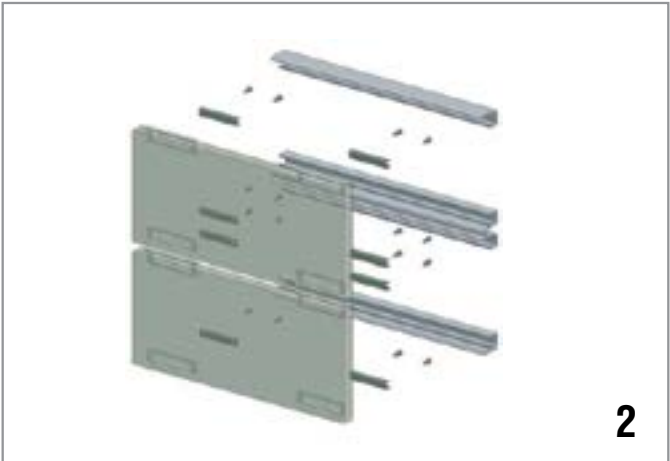
Utilizzando le apposite squadrette di posizionamento, applicare al pannello le clip di aggancio. Using the positioning angle, apply the hooking panel clips to the panel.
