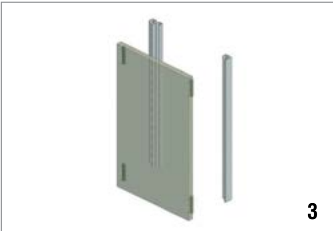
Fissare il pannello ai montanti. Fix the panel to the standbeam.
