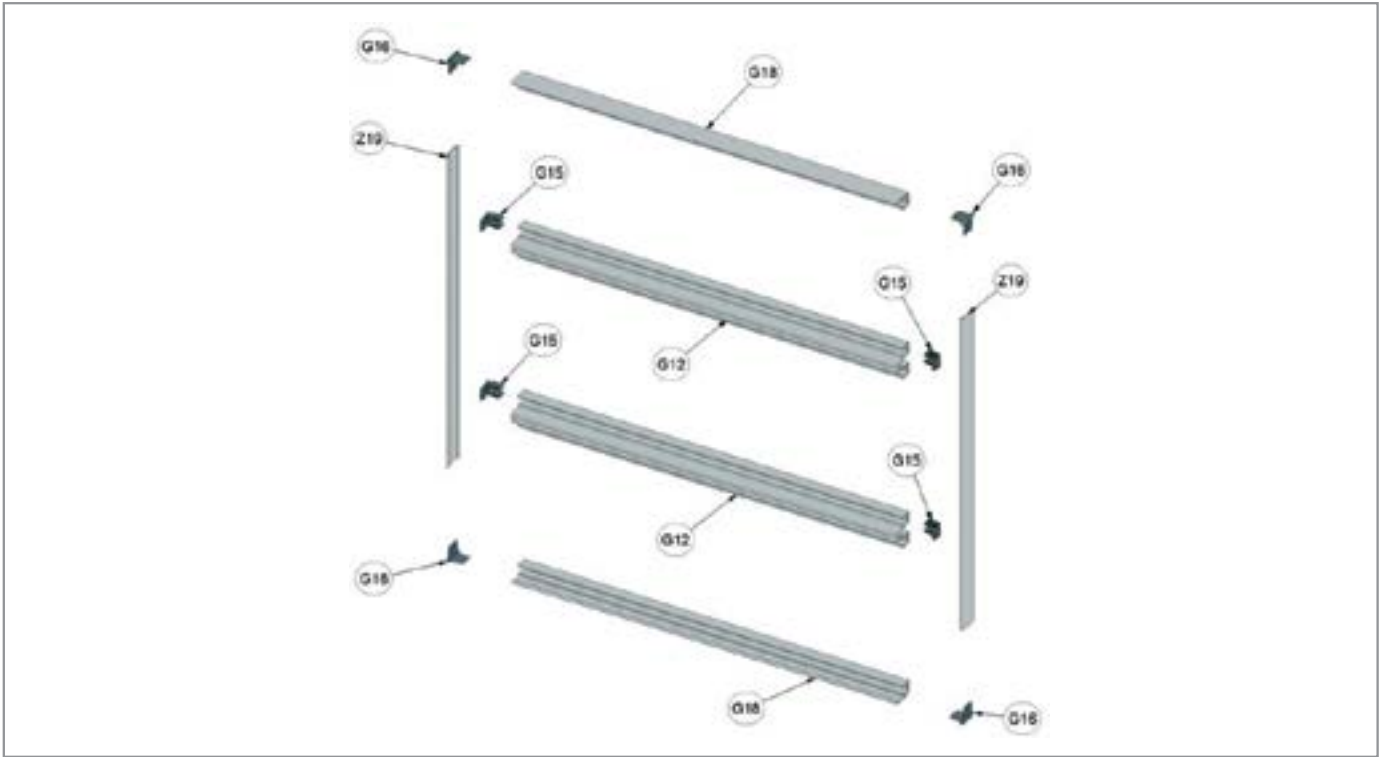
Schema di assemblaggio di pannellatura orizzontale Assembly plan of orizontal panelling
