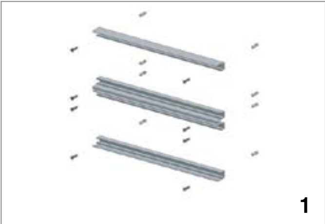
Fissare i traversi alla parete con gli appositi tasselli. Fiz the crosspiece to the wall using the apposite screw.
