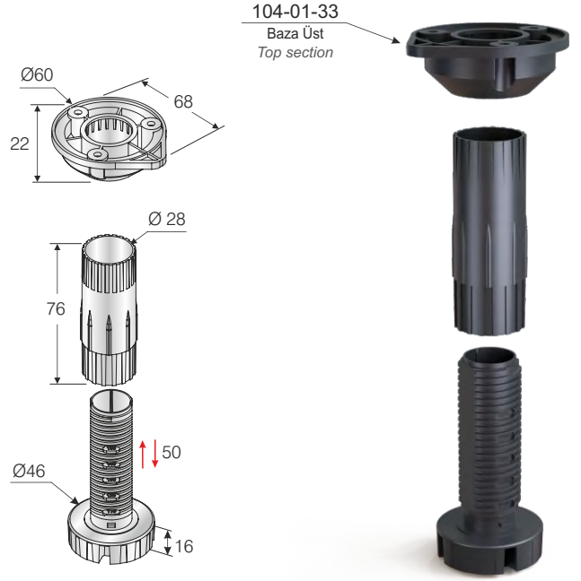
Baza Boru (3 parçalı) Foot and top section dismountable (100 - 150 mm)
